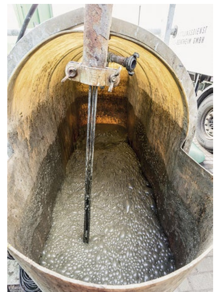
Dünngülle aus der Zentrifuge schäumt. In diesem Behälter kann sie sich beruhigen.
