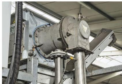
Im Gegensatz zu anderen Systemen zieht die Schnecke des Regenis GE 200 das zu separierende Produkt zur Antriebsseite hin.
