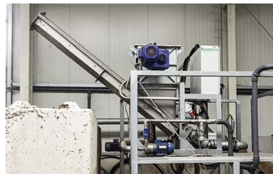
Der Pressschnecken-Separator Regenis GE 200 eignet sich für stationären Dauerbetrieb z. B. wie hier zum Separieren von Gärresten.
