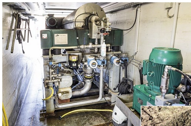
Die Zentrifuge im Lkw-Auflieger der RWG stammt von Huning. Fotos: Böhrnsen (1), Theißen (1), Tovornik
